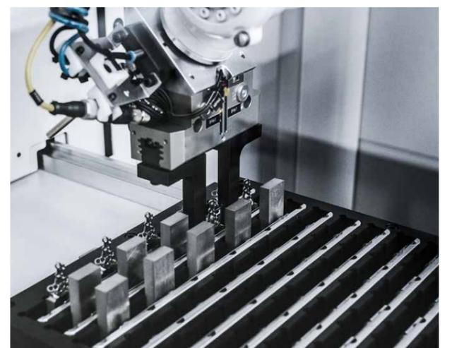
Eine von Medartis selbst konstruierte Werkstück-Palette mit Vielfach-Aufnahmen für die Bereitstellung von Titan-Rohlingen bzw. die Aufnahme von Fertigteilen, wobei das Handling durch den Roboter komplett automatisiert ist.
